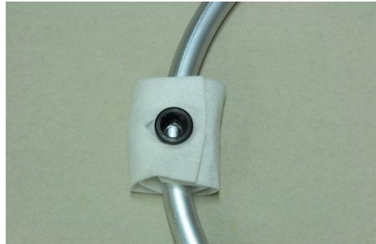
3. Ziehen Sie den Vlies-Streifen ein weiteres Mal sehr stramm um die Schelle und drücken Sie auch das dritte Loch über die Gewindemuffe. Jetzt kann die Alustange mit dem Gewinde eingeschraubt werden. Der Vliesstreifen kann dann nicht mehr verrutschen.
