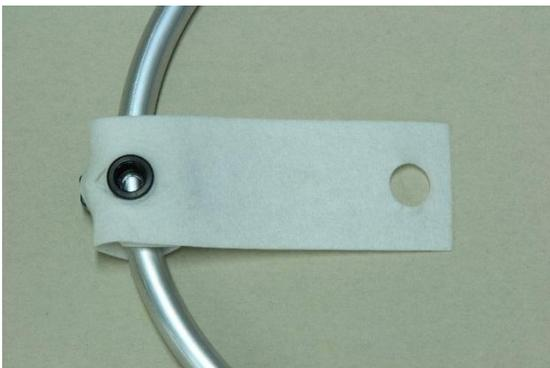
2. Ziehen Sie den Vlies-Streifen nach hinten stramm um die Schelle und drücken Sie auch das zweite Loch über die Gewindemuffe.
