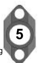
Drücken Sie diese Schale von oben auf den Ring und verschrauben Sie die beiden Halbschalen. Wichtig: Schraube von unten einschieben!
