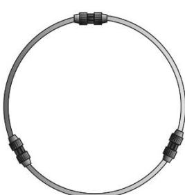
Wiederholen Sie das mit allen drei T-Stücken und den drei Kreis-Segmenten. Dadurch entsteht ein Ring mit etwa 1,3 m Durchmesser.
