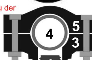
7) Schrauben Sie die drei Leichtmetall-Rohre mit den Gewindestücken in die Halbschalen mit den passenden Gewindelöchern. **Nur handfest anziehen.** Damit ist jetzt auch die obere Hälfte der Schwimm-Stütze fertig!
