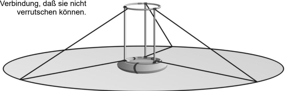
Ziehen Sie das Netz über die Schwimm-Stütze (geht am einfachsten gegen den Wind!). Stecken Sie das Netz mit den Haken am Ufer fest. Das Netz sollte straff gespannt sein.
