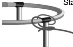
Ziehen Sie die Schwimm-Stütze an den unten befestigten Leinen zum gewünschten Standort. Spannen Sie die Leinen **gleichmäßig nach 3 Seiten ab** und befestigen Sie sie mit den Häringen.
