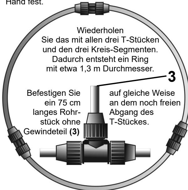
Befestigen Sie ein 75 cm langes Rohrstück ohne Gewindeteil (3) auf gleiche Weise an dem noch freien Abgang des T-Stückes.
