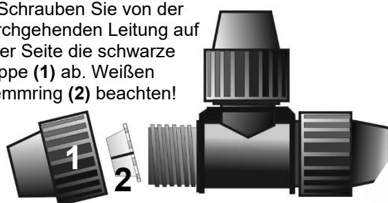
Schieben Sie erst die abgeschraubte Gewindekappe und dann den weißen Klemmring auf das Rohr.
