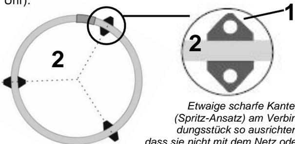
Drücken Sie den Ring (2) in die Schalen (1). Nehmen Sie eine Schale mit 3 Löchern (3). Das mittlere Gewindeloch hat einen Durchmesser von ca. 13 mm. Falls auf der Innenseite ein Gummiring liegt: Entfernen Sie ihn bitte. Drücken Sie diese Schale von oben auf den Ring und verschrauben Sie die beiden Halbschalen. **Wichtig:** Schraube von unten einschieben.
