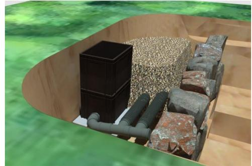
Seitliche Ansicht auf den Pumpenschacht mit zwei Vorfiltern am Ende des Filtergrabens. Die lückige Mauer hält den Kies im Ansaugbereich des Vorfilters, so ist eine verlangsamte Strömungsgeschwindigkeit und längere Standzeit zu erwarten.
