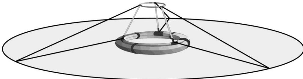
Ziehen Sie das Netz über die Schwimm-Stütze (geht am einfachsten gegen den Wind!). Stecken Sie das Netz mit den Haken am Ufer fest. Das Netz sollte straff gespannt sein.
