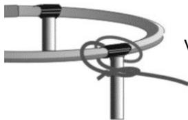
Befestigen Sie je eine Leine an jeder Verbindungsstelle zwischen Stangen und Ringen, also oben und unten jeweils 3 Stück. Schlingen Sie sie so um die Verbindung, dass sie nicht verrutschen können.
