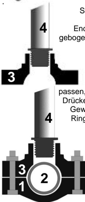
Schrauben Sie je eine dieser Halbschalen auf die beiden Enden des zu einem Halbkreis gebogene Leichtmetall-Rohres (4). **Nur handfest anziehen.**
