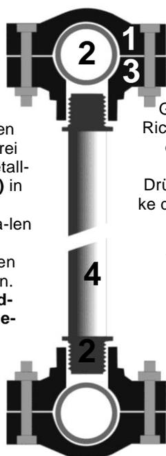
Schrauben Sie drei weitere Halbschalen handfest auf das obere Gewinde-Ende der Rohre. Richten Sie sie so aus, dass der zweite Ring eingelegt werden kann. Drücken Sie die Gegenstücke der Gewinde-Halbschalen über den Ring und verschrauben Sie sie. **Wichtig: Die Schrauben werden jetzt von oben eingesteckt.** Richten Sie die Konstruktion aus und ziehen Sie jetzt die Schrauben fest.
