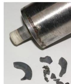
Ein erstes Warnzeichen ist eine Verringerung der Wassermenge. Die Verkalkung kann durch Entkalker wieder aufgelöst werden. In Extremfällen wie auf den gezeigten Fotos bleiben jedoch dauerhafte Schäden, die die Lebenserwartung der Pumpe verkürzen und die Förderleistung reduzieren.
