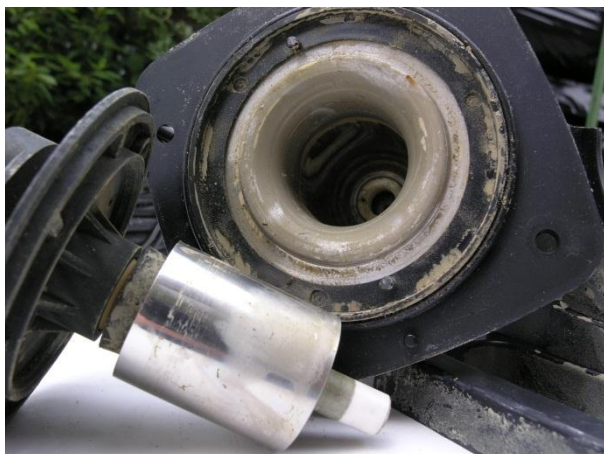
Leichter Kalkansatz – mehr sollte es nicht werden.
